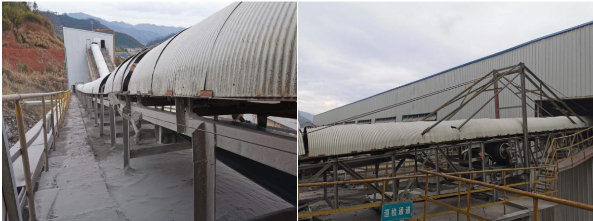
图 1-8 现有胶带机通廊封闭型式
