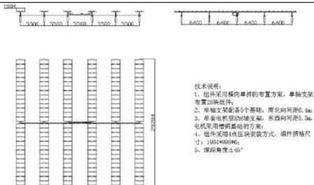
图 2.1-5 平单轴跟踪光伏支架方案图
