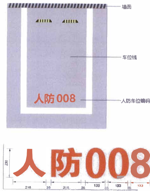
图 8 喷涂式车位标识样式及尺寸示例
