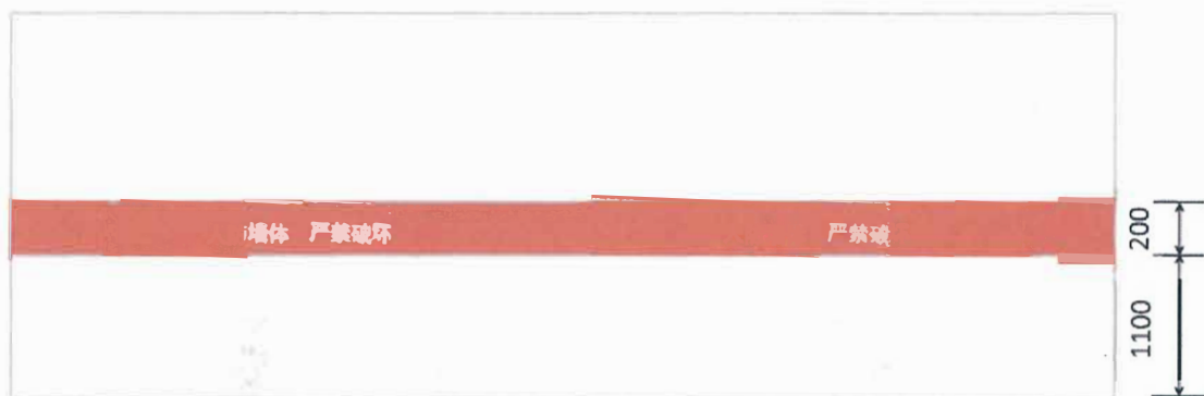
图 5 应配建区墙体标识样式及尺寸示例
