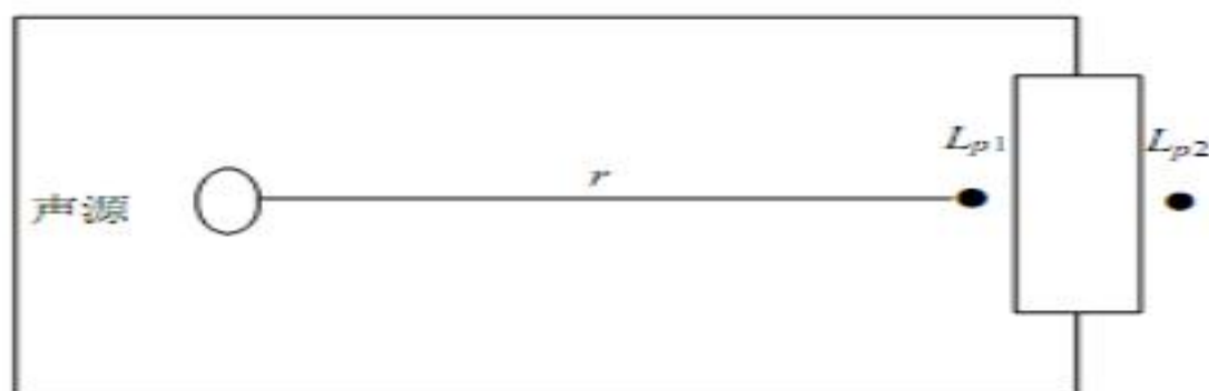
图 4-4 室内声源等效为室外声源图例
