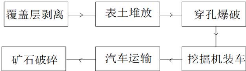
图3-4 露天开采工艺流程示意
