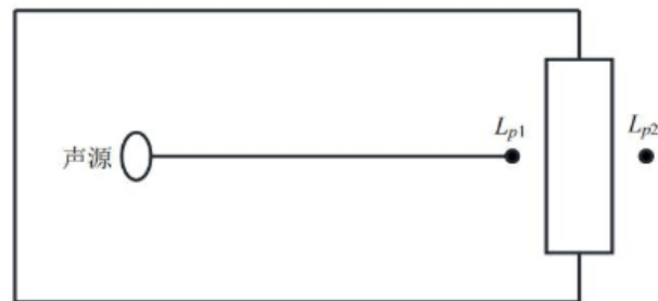
图 4-2 室内声源等效为室外声源图例
